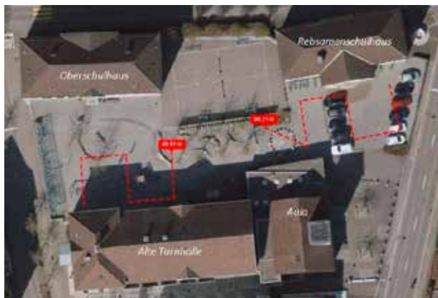
Abbildung 1: mögliche Einteilung der Erdsonden (Quelle: Machbarkeitsstudie KEEST)
